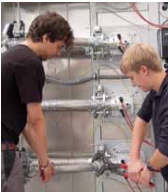
Montage eines Begasungssystems an einem Herdwagenofen
