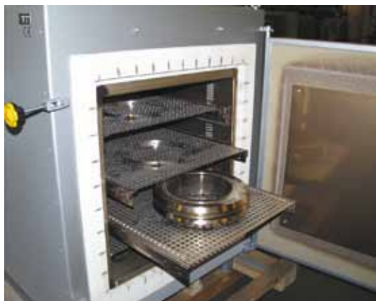
Cámara del horno con rejillas de carga en el horno de aire circulante. Las unidades insertables se guían individualmente sobre barras telescópicas pudiendo ser extraídas por separado.
