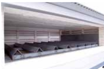
N 1760/S zum Vorwärmen von Blechen mit Chargenauflage
