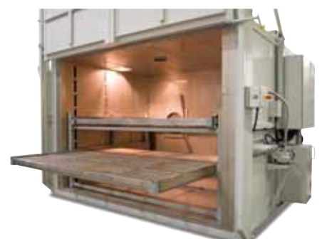
Schubladensystem zum Chargieren auf mehreren Ebenen
