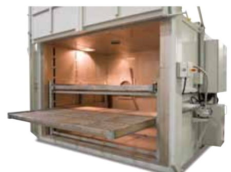
Sistema a cassette per il caricamento su più livelli
