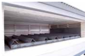
N 1760/S per il preriscaldamento di lamiere con piano di caricamento
