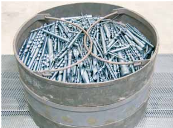
Ricottura blu di alesatori con vapore acqueo in un forno della serie NRA vedi pagina 12
