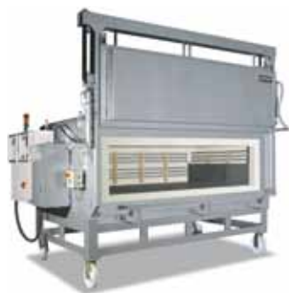
Forno di ricottura con porta a sollevamento elettroidraulico e basamento mobile per il preriscaldamento di componenti in lamiera di grandi dimensioni per l'industria automobilistica vedi pagina 42
