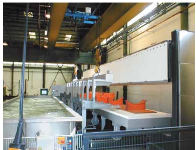
Impianto di bonifica manuale per la tempra di barre di acciaio vedi pagina 62/63
