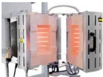
RS 100/250/11S in aufklappbarer Ausführung zum Einbau in eine Prüfvorrichtung
