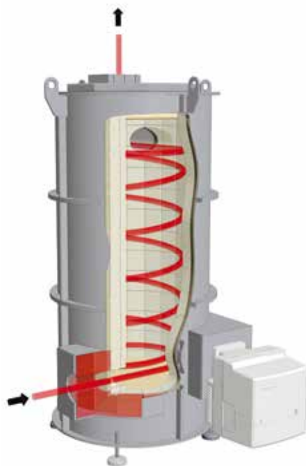
Schematische Darstellung einer thermischen Nachverbrennung (TNV)
