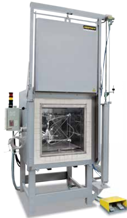
Messgestell zur Ermittlung der Temperaturgleichmäßigkeit
