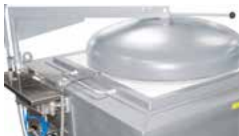
Schmelzbadregelung mit Thermoelement in der Schmelze
