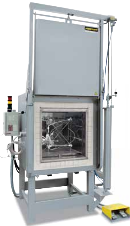
Bâti de mesure pour déterminer l'homogénéité dans la répartition des températures
