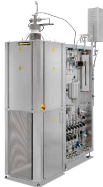
RHTV 120/600/17 H<sub>2</sub> mit Begasungspaket 4 für brennbare Gase, schwenkbarem Haken zum Aufhängen der Charge und Sicherheitstür vor dem unteren Flansch
