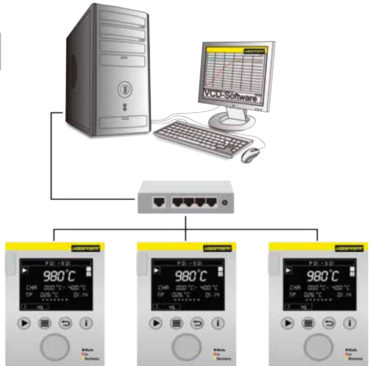
Beispielaufbau mit 3 Öfen
