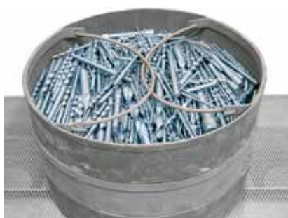
Bläuen von Bohrern mit Wasserdampf in einem Ofen der Baureihe NRA siehe Seite 14
