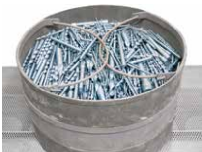
Bleuissage de forets à la vapeur dans un four de la série NRA voir page 16
